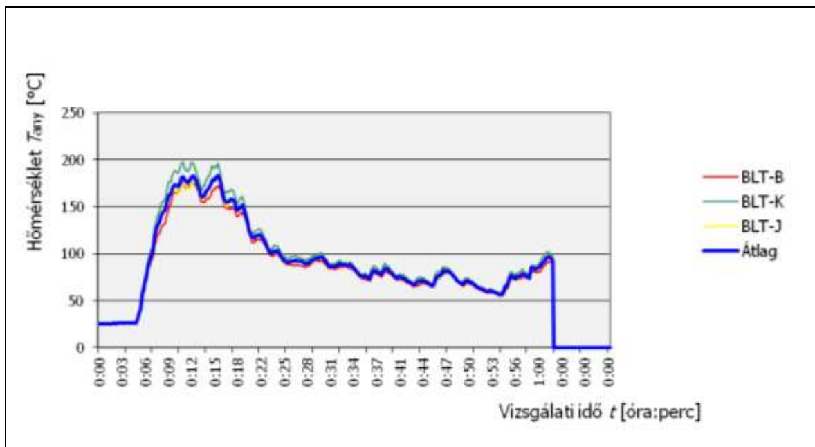
2. grafikon. Megfigyelőtéri hőmérséklet regisztrátuma egy homlokzati hőszigetelő rendszer vizsgálata során.
